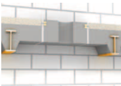
Перекрытие со стальными балками
