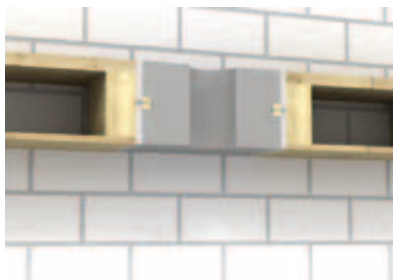
Перекрытие с деревянными балками без подшивного потолка
