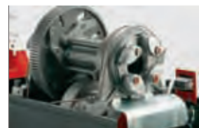
SUPER GRIP система зажимания трубы
