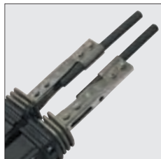
Пара круглых стержневых электродов с держателем
