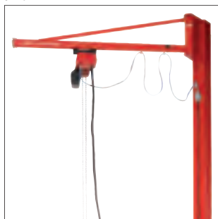
Прочное электрическое подъемное устройство
