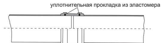
Рисунок 20 – Простое соединение эластичного типа, с уплотнительной прокладкой (эластомер)
