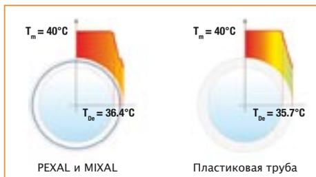
Температура на поверхности трубы (пример).
