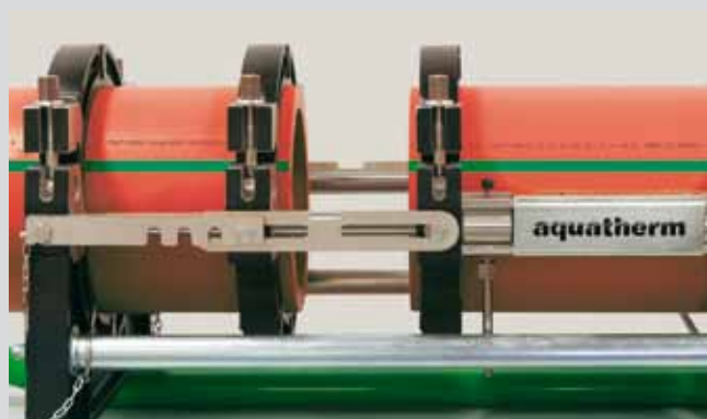
Свариваемые части вставить, выровнять и зафиксировать
