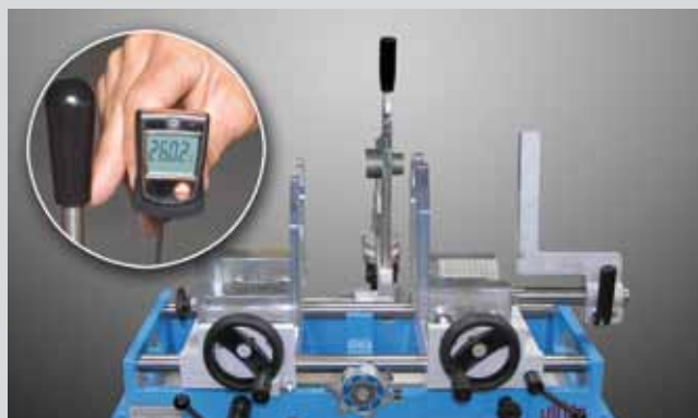
Измерение темп. на сварочном аппарате aquatherm
