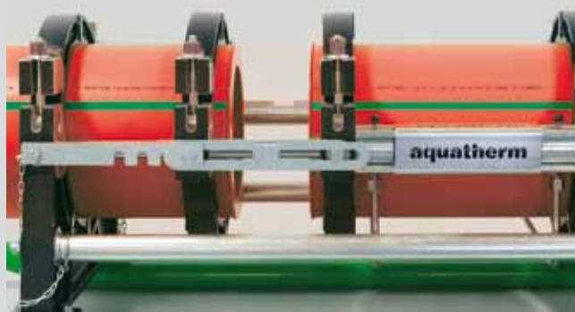
Трубы развести, удалить нагревательный элемент
