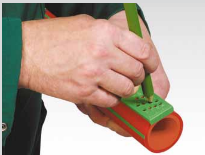
Отметка глубины сварки
