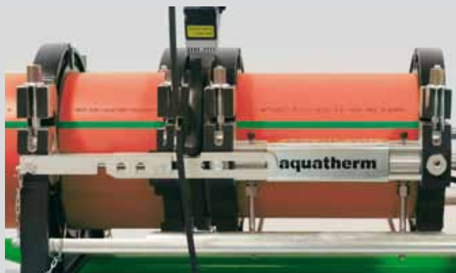
Вставка сварочного элемента
